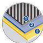
Para montar a estrutura, são prensadas fibras de carbono (1), resina (2) e película de suporte (3).
