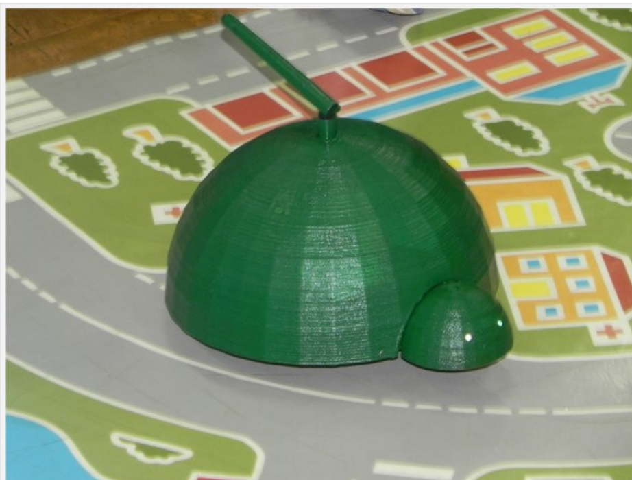
Champ recebe comandos com processador interno e transmissor wireless
