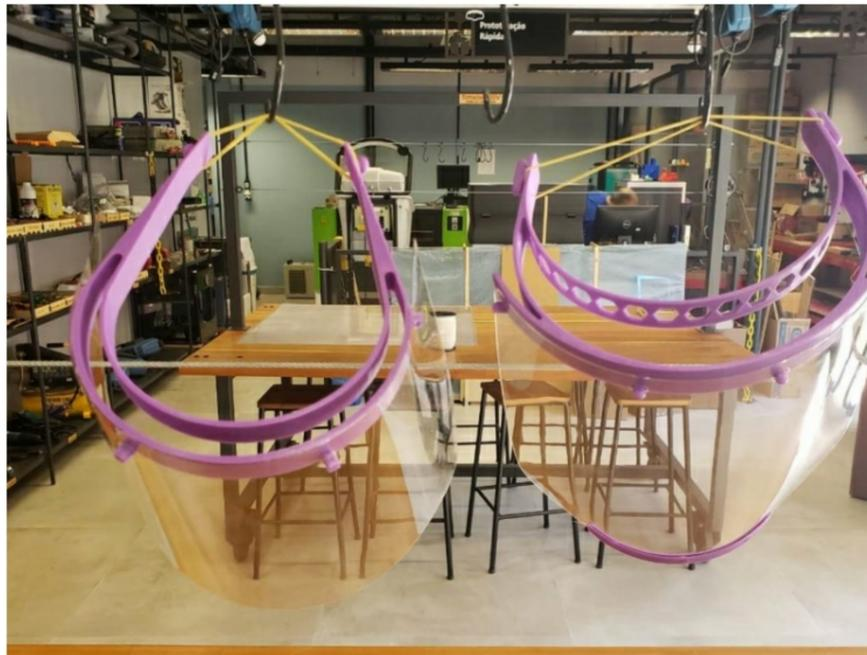
Equipamento de proteção será usado nos hospitais e é fabricado em uma impressora 3D
